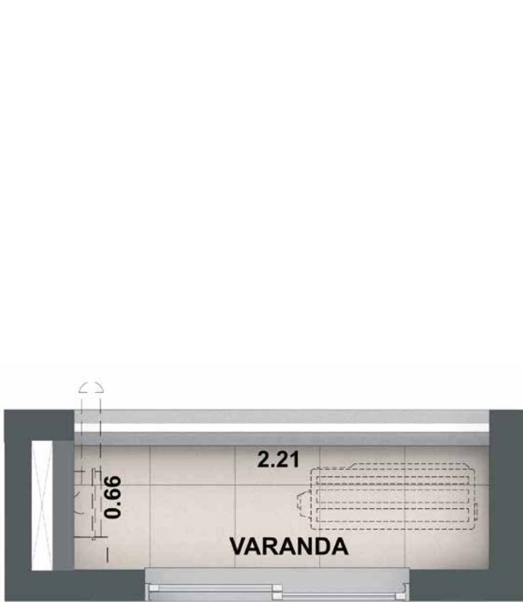
ALTERAÇÃO DAS VARANDAS DAS COLUNAS 22/23 (TÉRREO) E 25/26 (2º AO 18º PAVIMENTO) DA TORRE 01.
